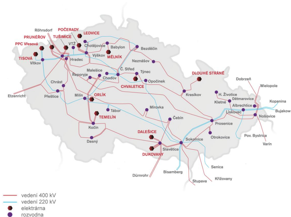
Obrázek 4- Schéma rozvodné sítě v České republice
